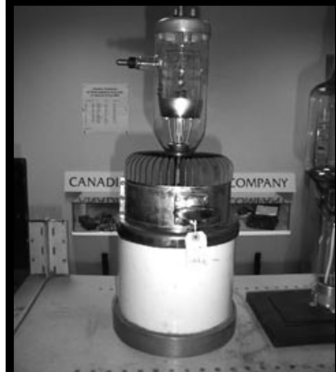
LAMPE D'AMPLIFICATION RF MODÈLE #872F (7,5 KW AM) IDENTIQUE À CE QU'UTILISE L'ÉMETTEUR ONDES-COURTES DE RADIO-CANADA À CONTRECŒUR À PARTIR DE 1940 POUR LA DIFFUSION DE MESSAGE EN DIRECTION DE L'EUROPE (REFROIDISSEMENT PAR AIR PULSÉ, POIDS APPROXIMATIF DE 25 KILOS).
